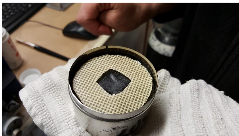
Figur 4. Bitumenprov med silikonmall för talkapplicering
